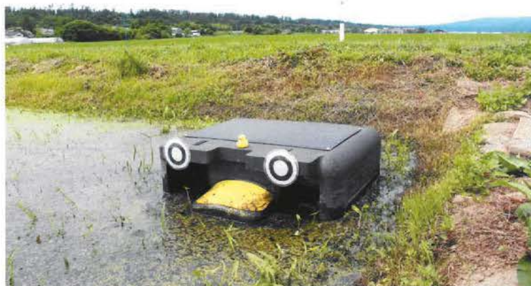
抑草作業をするアイガモロボ。底にブラシ型パドルが付いており、上部にはソーラーパネルを搭載している。
