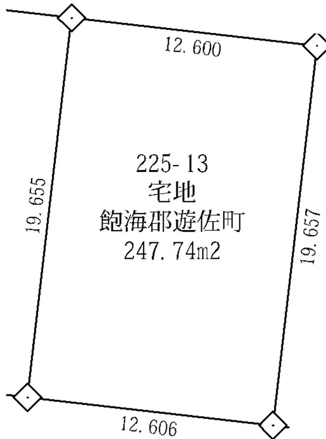
※確定測量図（縮尺1/500）より抜粋していますが、拡大して使用していますので
