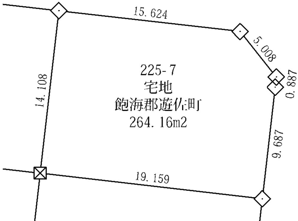
※確定測量図（縮尺1/500）より抜粋していますが、拡大して使用していますので
